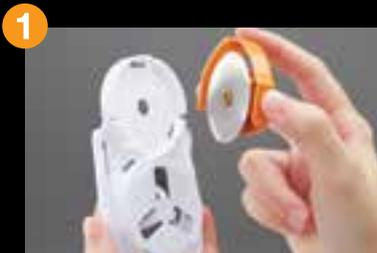
1. Transferir la cuchilla usada en la herramienta de cambio de cuchilla y darle la vuelta
